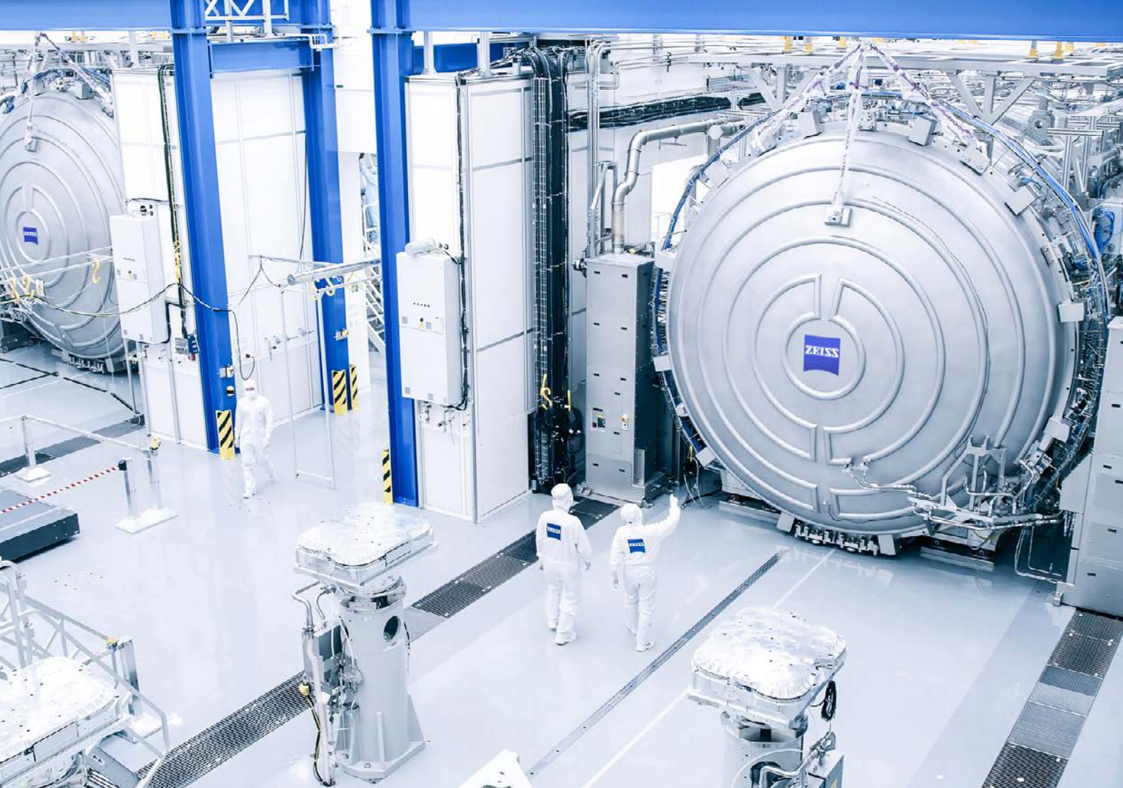
Zeiss Oberkochen: In gigantischen Vakuumkammern mit einem Durchmesser von fünf Metern werden hochpräzise Spiegel für die High-NA-EUV-Technologie vermessen – ein Verfahren für die Chip-Produktion. | Foto: ZEISS Semiconductor Manufacturing Technology (SMT)
