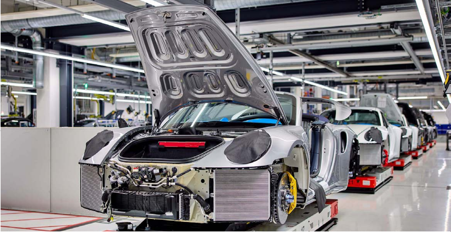
Fahrerlose Transportsysteme (FTS) im Porsche-Stammwerk Stuttgart-Zuffenhausen: Hier werden die Baureihe 911 und der elektrische Taycan produziert. | Foto: Dr. Ing. h.c. F. Porsche AG
