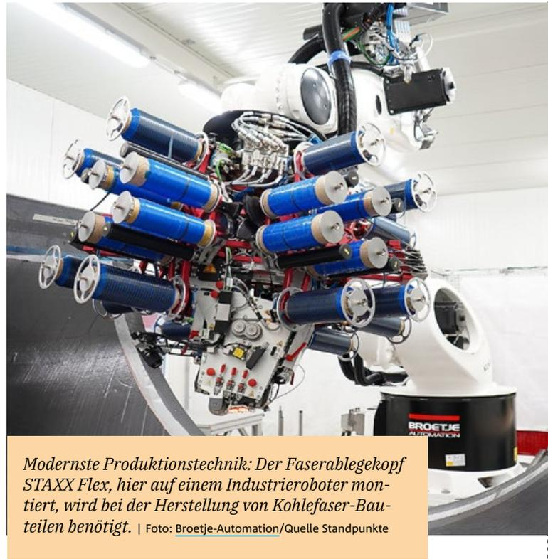
*Modernste Produktionstechnik: Der Faserablegekopf STAXX Flex, hier auf einem Industrieroboter montiert, wird bei der Herstellung von Kohlefaser-Bauteilen benötigt. | Foto: Broetje-Automation/Quelle Standpunkte*
